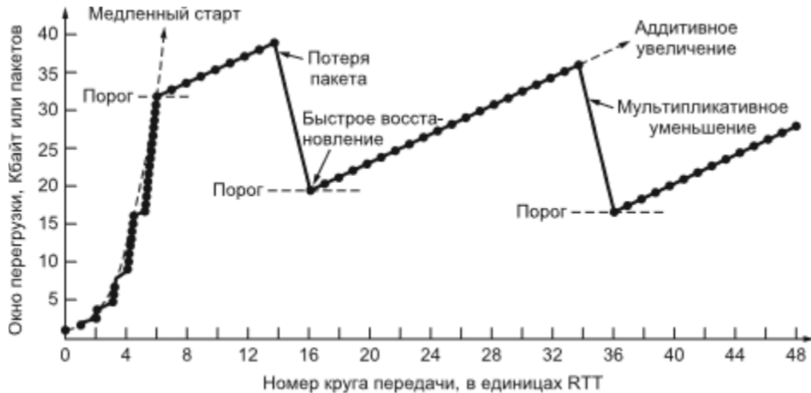
Рис. 6.41. Быстрое восстановление и пилообразный график для TCP Reno
